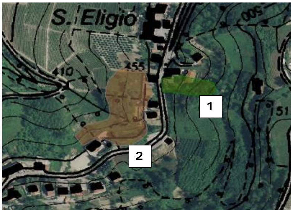
Perimetrazione delle recenti frane in località S. Eligio del comune di Monforte d'Alba. 1- scivolamento rotazionale evoluto in colamento rapido 2-scivolamento planare incipiente (figura non in scala, base topografica CTR + ortofoto IT2007)
