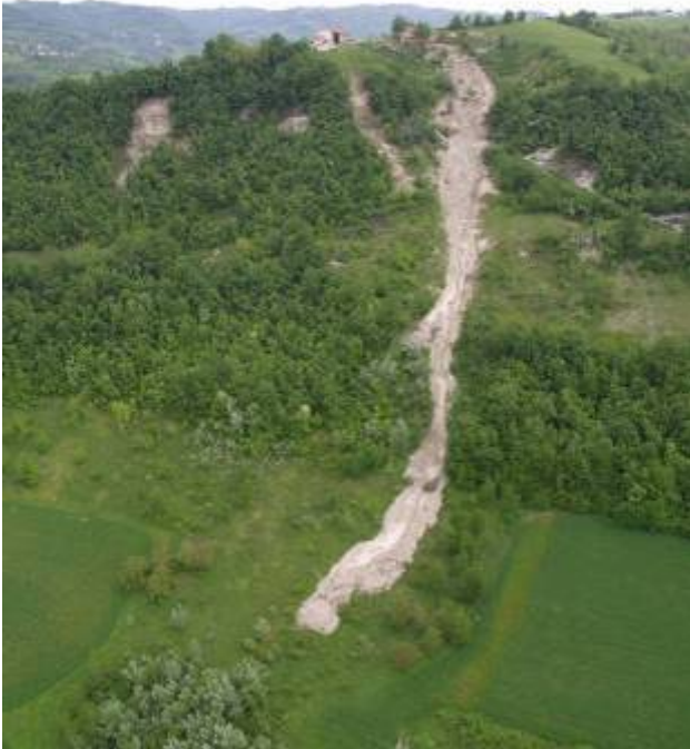
Ceva, C. Gorrettie. Scivolamento rotazionale evolutosi in colamento veloce
