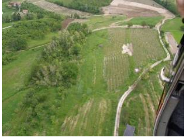
Bastia Mondovì, Montechiaro. Riattivazione di un'ampio scivolamento planare attivatosi a marzo 2009
