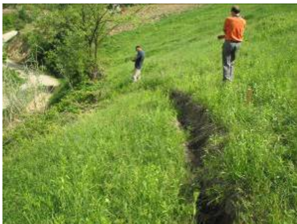
Comune di Canelli: a sinistra, fessura posta pochi metri dietro il cascinale; a destra, la scarpata principale del fenomeno, collocata al confine tra il prato e gli arbusti, dietro il cascinale.
