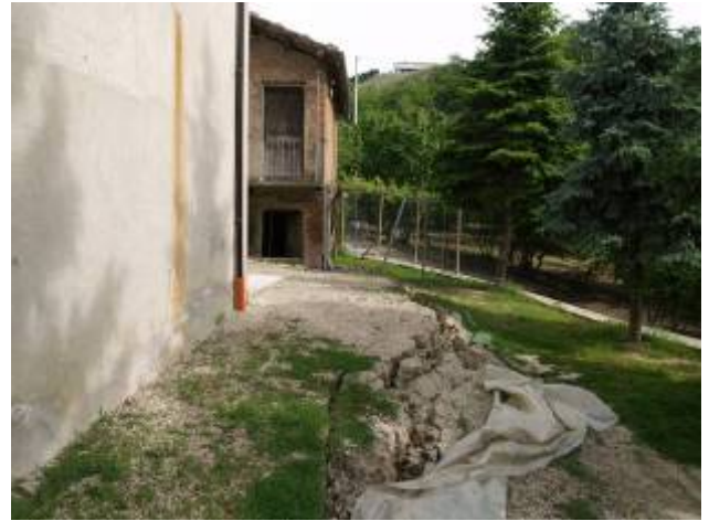
Carno, C. Nosetti. Vasto scivolamento planare. Il coronamento ha lambito la cascina
