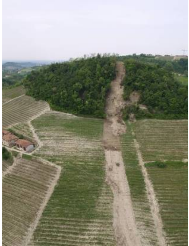
Monforte d'Alba, Bric dell'Asciullo. Colamento veloce per fluidificazione della colture superficiale
