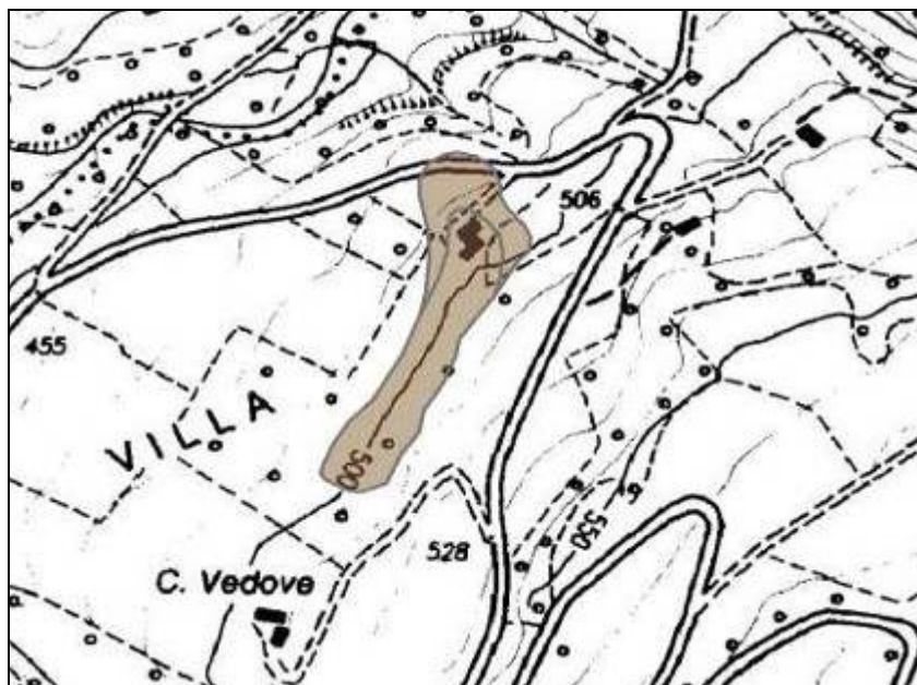
Perimetrazione della frana planare di località Villa. Il poligono che interessa la strada provinciale rappresenta l'estensione subita dalla frana in occasione delle piogge di fine aprile 2009 rispetto alla situazione di marzo 2009 (figura non in scala)
